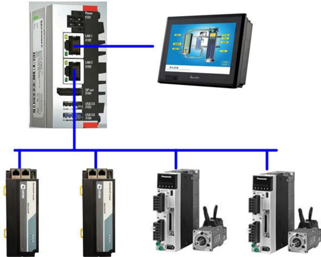
通讯总线协议采用标准的Modbus/TCP通讯总线，可以方便的与Modbus/TCP的PLC或者工控机实现无障碍连接。通讯接口方式为2个RJ45百兆以太网接口，且内部实现端口交换功能，无需另外增加交换机，可以轻松实现多个从站级联。
